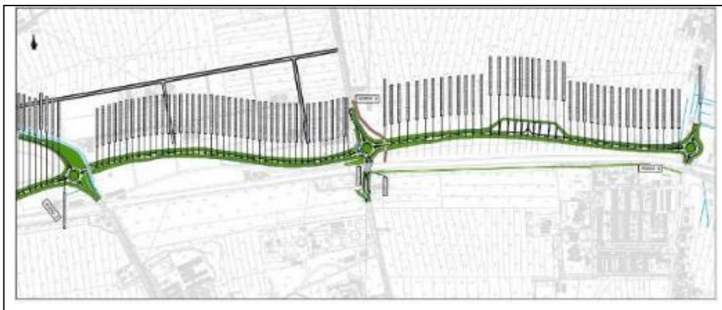
Figura 37 Stralcio planimetrico con tombini di trasparenza idraulica previsti lungo i nodi da 3 a 5. Lungo i nodi da 2 a 5 vi è la stessa tipologia di sistemazione, per un numero totale di 111 tombini diametro interno 800 mm.
