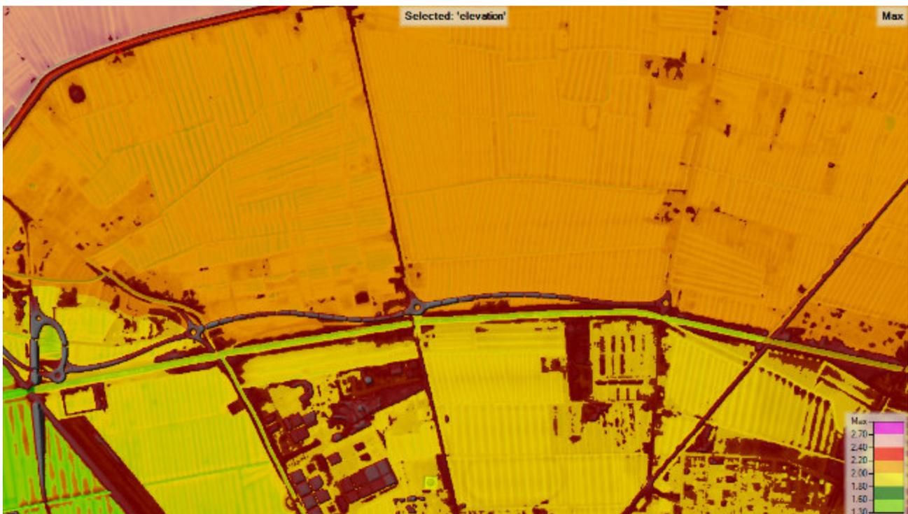
Figura 10 Involuppo dei massimi delle superfici idriche per stato di progetto simulazione Tr 200 anni
