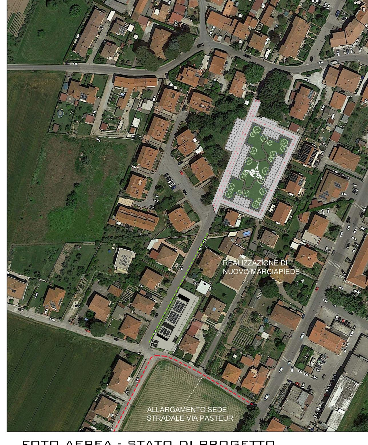
FOTO AEREA - STATO DI PROGETTO REALIZZAZIONE DEL NUOVO TRATTO DI MARCIAPIEDE E ALLARGAMENTO SEDE STRADALE VIA L. PASTEUR
