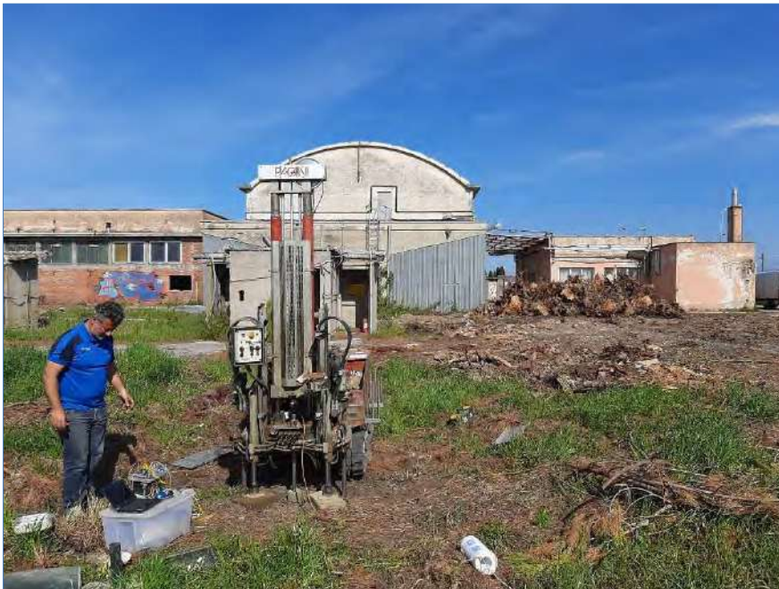
Figura 1: Prova penetrometrica CPTU 01
