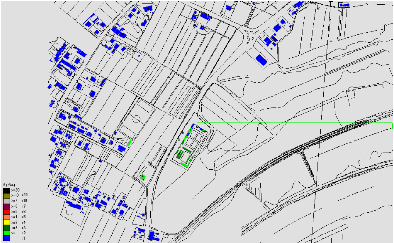
Fig. 54 Impatto elettromagnetico – zona Cimitero Comunale Ghezzeno – vista dall'alto
