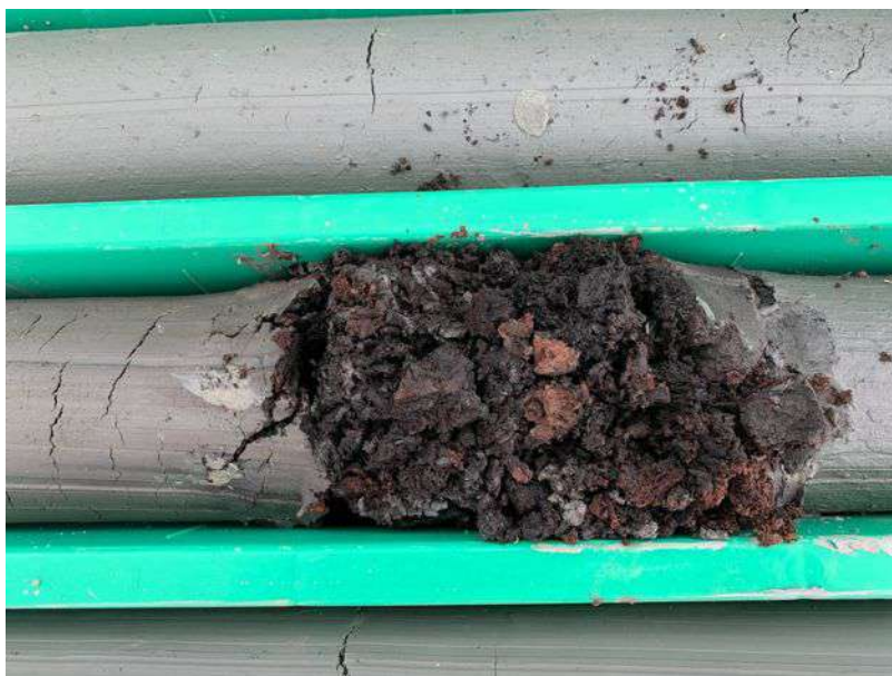
Foto n.14 : Particolare dell'orizzonte torboso tra -21,00 e -22,00 m lungo la verticale del sondaggio S1.
