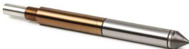
Figura n.14 : Punta piezocono per prova CPTU
