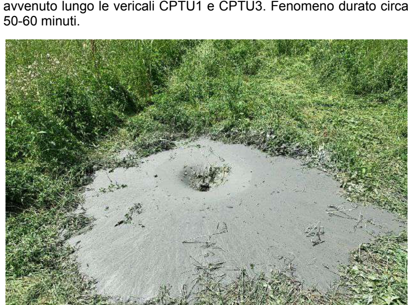
Formazione di cono sub-appiattito di sabbia centrato sul foro della prova CPT2, al termine del fenomeno eruttivo di gas e di acqua mista a sabbia.
