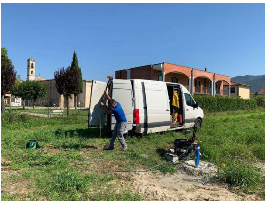
Foto n.2 : Generazione delle perturbazioni elastiche sismiche nell'indagine Down Hole.
