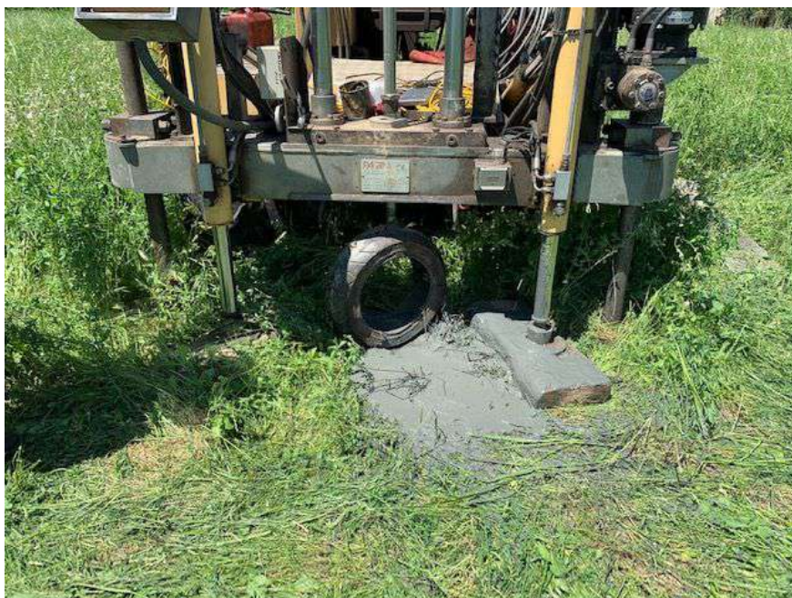
Foto n.9 : Eruzione di gas con acqua mista a sabbia in corrispondenza della prova CPTU1.
