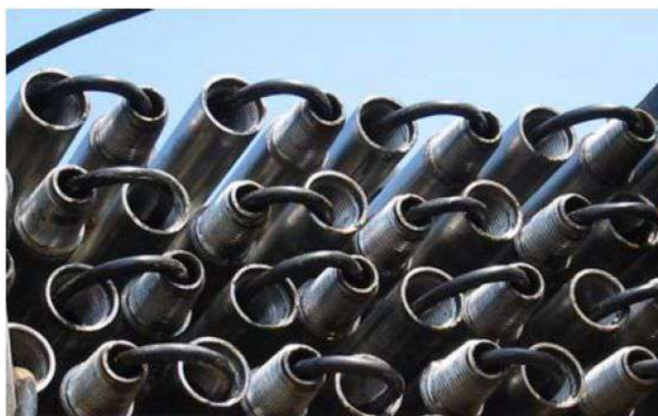
Figura n.17 : Cablaggio elettronico interno alle aste
