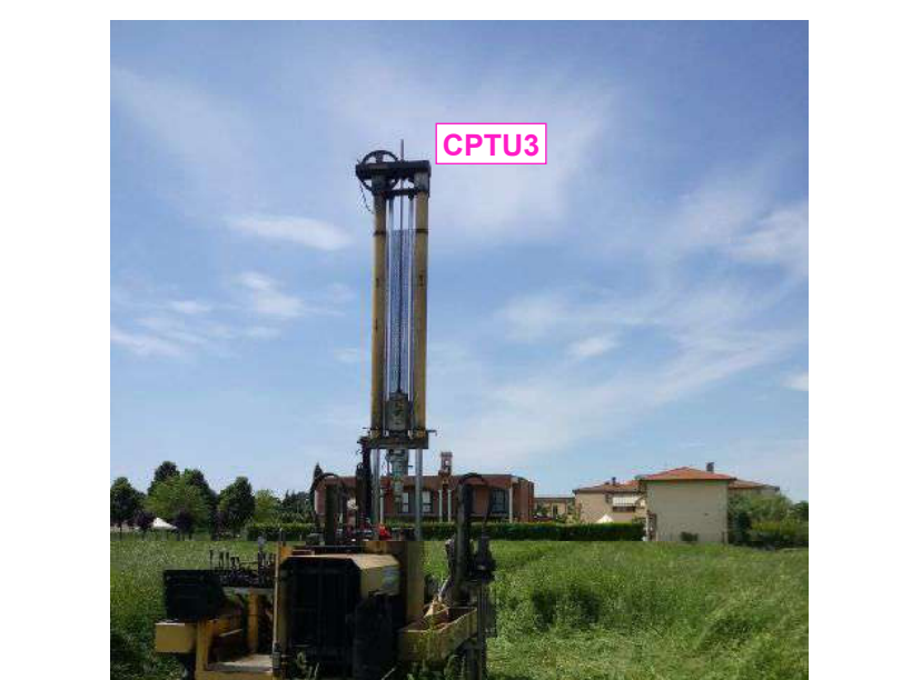
Postazione CPTU3 (prova penetrometrica statica con punta piezozono).
