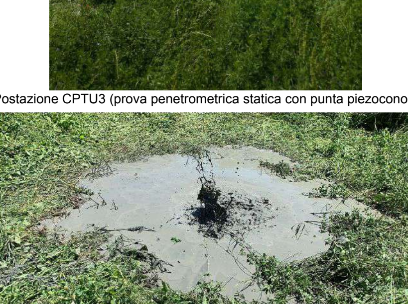
Piccola eruzione di gas e di acqua mista a sabbia dal foro della prova CPTU3, al termine della estrazione dell'ultima asta, come avvenuto lungo le verticali delle prove CPT2 e CPTU1. Fenomeno durato circa 50-60 minuti ed apprezzato, in misura minore, nel sondaggio S2 eseguito successivamente in vicinanza alla CPTU3.
