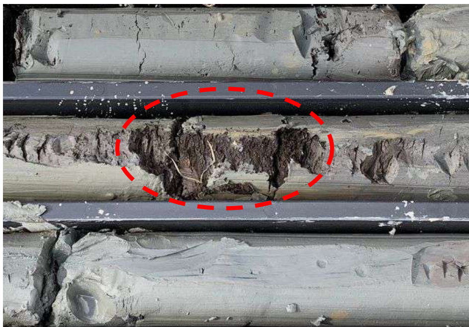
Foto n.15 : Particolare dell'orizzonte torboso tra -11,00 e -12,00 m lungo la verticale del sondaggio S2.
