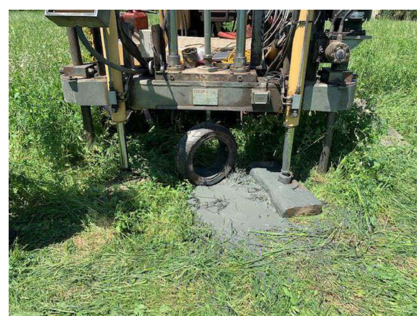
Piccola eruzione di gas e di acqua mista a sabbia dal foro della prova CPTU1, al termine dell'estrazione dell'ultima asta. Fenomeno durato circa 50-60 minuti, verificatosi anche lungo le verticali delle prove CPT2 e CPTU3 ed apprezzato, in misura minore, nel sondaggio S1 eseguito successivamente in vicinanza alla CPTU1.
