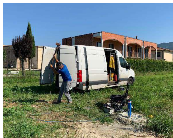
Esecuzione prova sismica Down Hole.
