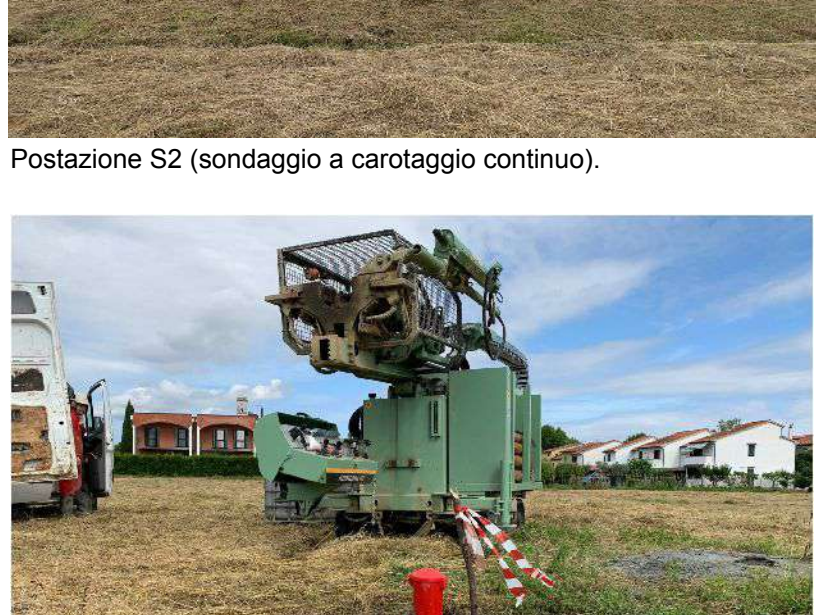
Cappuccio a fungo a protezione della testa del piezometro in S2.
