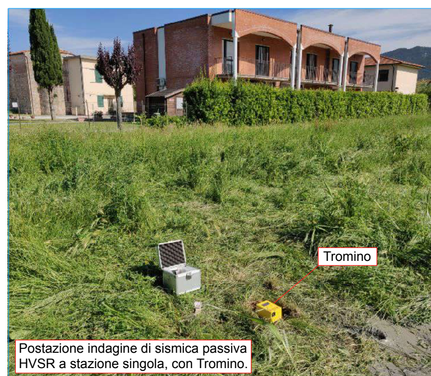
Postazione indagine di sismica passiva HVSR a stazione singola, con Tromino.
