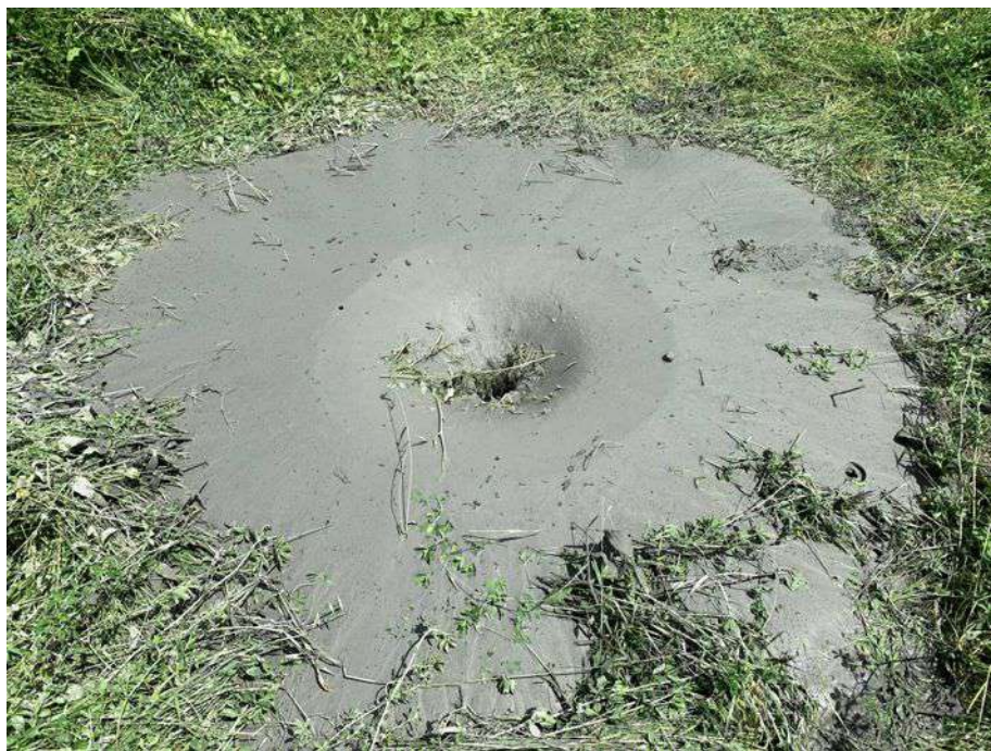
Foto n.12 : Cono di sabbia in corrispondenza della prova CPT2.
