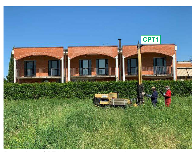
Postazione CPT1 (prova penetrometrica statica con punta meccanica)
