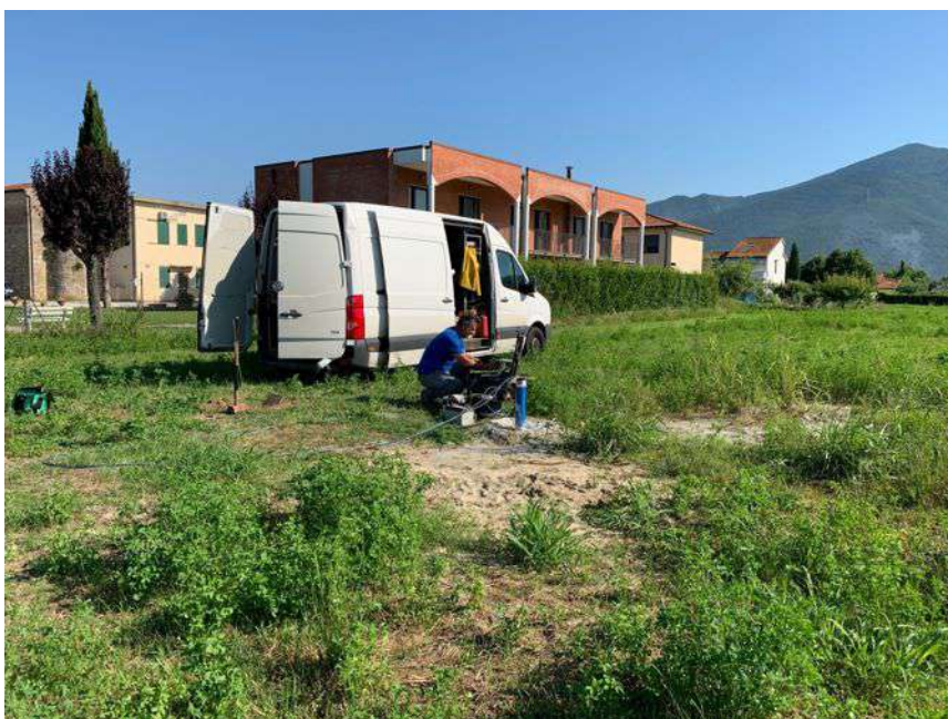
Foto n.1 : Esecuzione dell'indagine sismica Down Hole nel foro del sondaggio S1.
