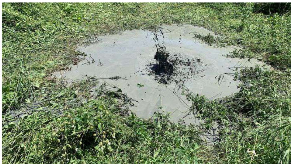
Foto n.10 : Eruzione di gas con acqua mista a sabbia in corrispondenza della prova CPTU3.
