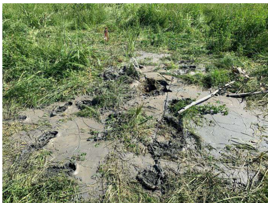
Foto n.11 : Cono di sabbia molto appiattito in corrispondenza della prova CPTU1.
