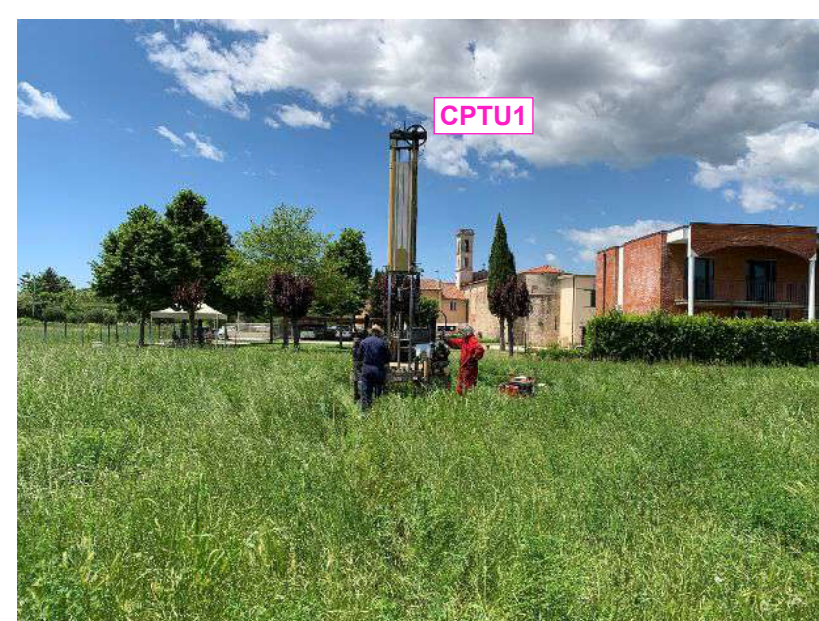
Postazione CPTU1 (prova penetrometrica statica con punta elettrica-piezozono).
