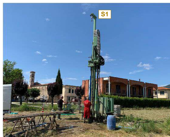
Calo della tubazione in PVC per prova sismica Down Hole nel foro del sondaggio S1.
