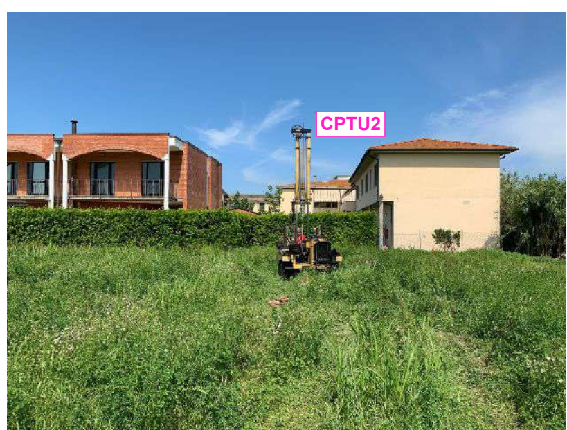
Postazione CPTU2 (prova penetrometrica statica con punta elettrica-piezozono).
