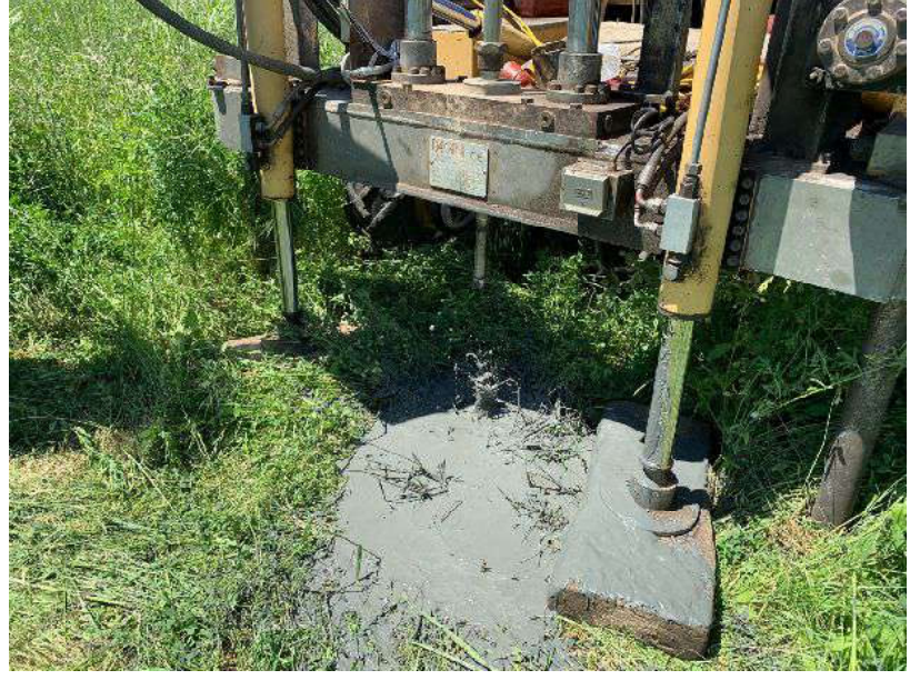
Piccola eruzione di gas e di acqua mista a sabbia dal foro della prova CPT2, al termine della estrazione dell'ultima asta, come avvenuto lungo le verticali CPTU1 e CPTU3. Fenomeno durato circa 50-60 minuti.
