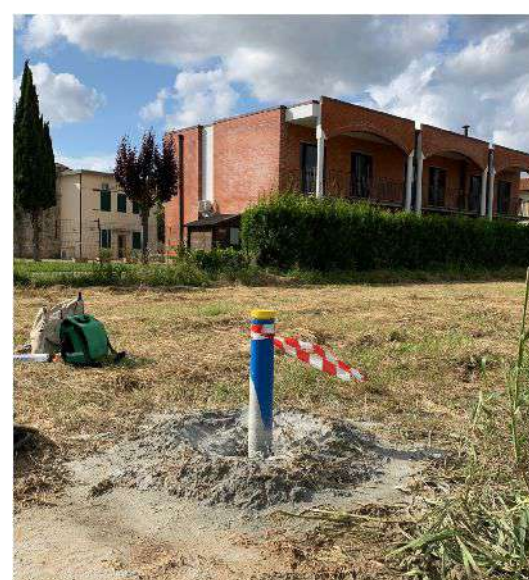
Testa fuori terra della tubazione cementata per prova sismica Down Hole.
