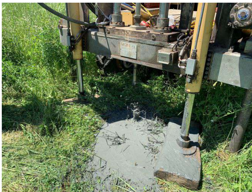
Foto n.8 : Eruzione di gas con acqua mista a sabbia in corrispondenza della prova CPT2.
