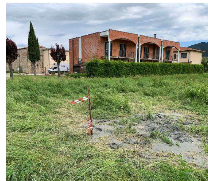
Formazione di cono sub-appiattito di sabbia centrato nel foro della prova CPTU1, al termine del modesto fenomeno eruttivo di gas e di acqua mista a sabbia.
