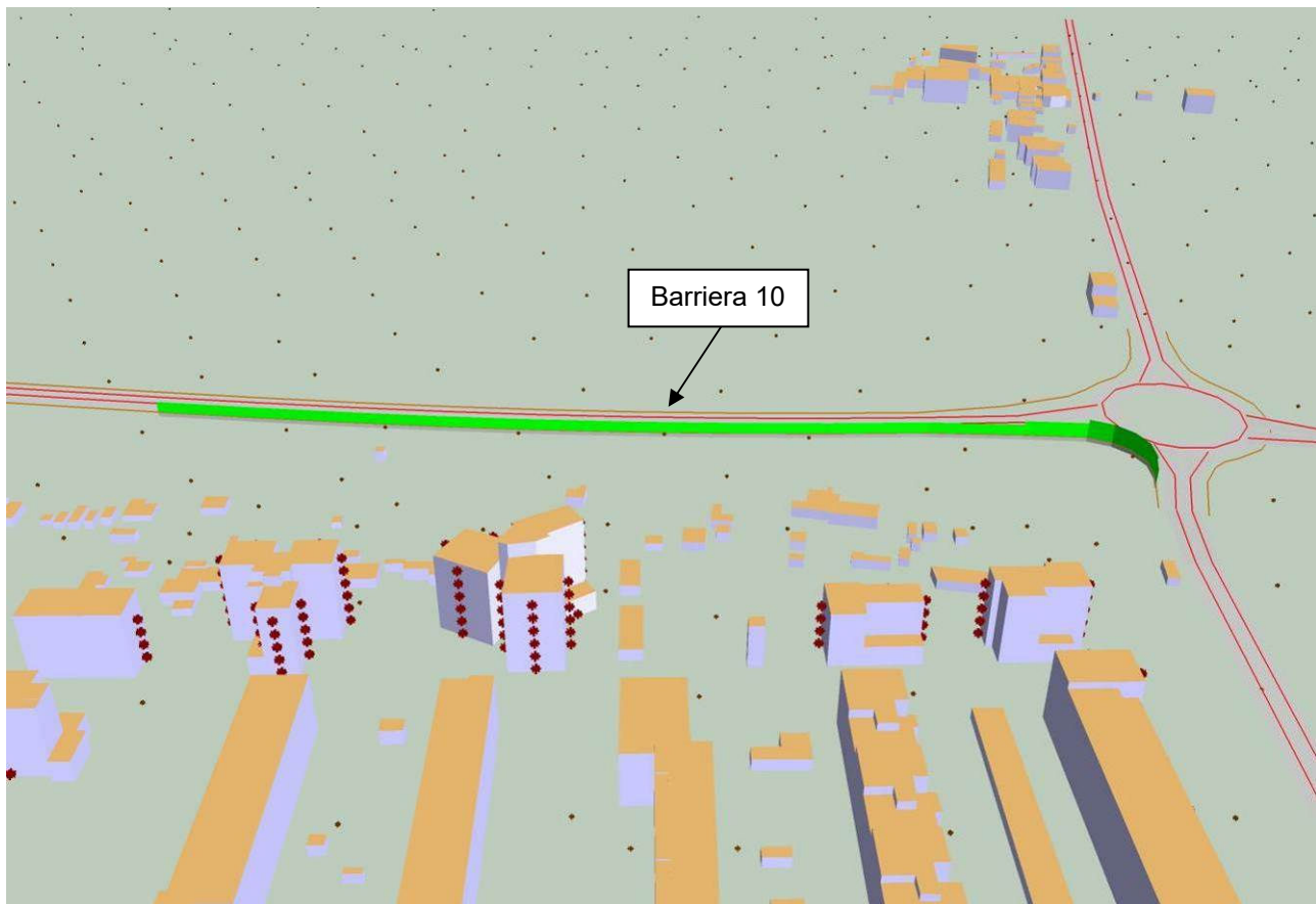
Figura 35 Ingegnerizzazione dei sistemi di mitigazione – Area limitrofa al quartiere I Passi/nodo 5 - Disposizione planimetrica ed altezza dei segmenti di barriere ottimizzate
